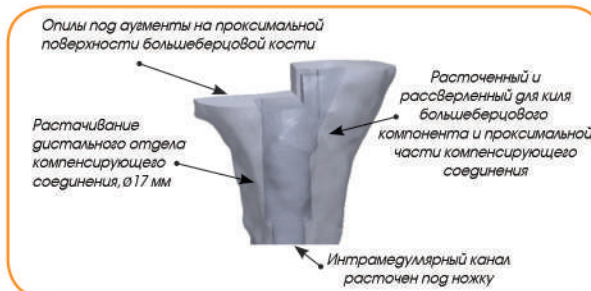
Рисунок T11. Подготовленная большеберцовая кость (Показано для случаев компенсации)
