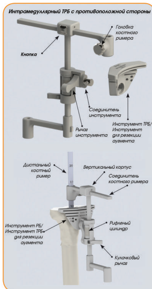
Рисунок Т2. Сборка тибиального резекционного блока
