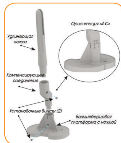
Рисунок 111 б. Сборка компонентов тибиального имплантата (включая тибиальную компенсацию)
